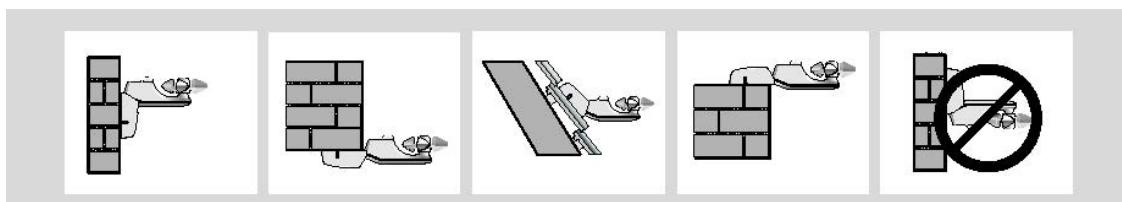
Polohovací raménko slunečního a větrného čidla umožnuje zvolit montáž podle místních podmínek. **Není dovoleno montovat čidlo vrtulkou dolů!**
