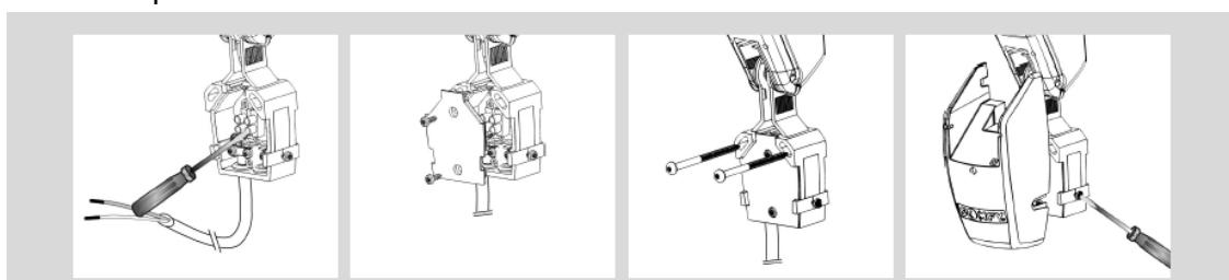
Přívodní kabely zapojte na správné svorky.
