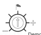
Pro testovací a předváděcí účely je možné provozní reakční a čekací doby zkrátit na časy v trvání řádu sekund. Potenciometr "VÍTR" nastavte pro tento případ do polohy "DEMO".
