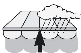
V případě, že dešťové čidlo rozezná dešťové srážky, je vydán povel NAHORU pro zajetí markýzy/žaluzie. **Pokud tento stav trvá, pohony/přijímače ignorují jakýkoliv povel k chodu** - jak manuální z dálkových ovladačů, tak i ze sluneční automatiky.
