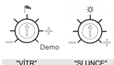
Prahové hodnoty, jejichž překročení automatika sleduje, se nastavují potenciometry "SLUNCE" a "VÍTR". Potenciometry jsou umístěny zespoda (viz obr. v kap. 3.2 a 3.3) na raménku Soliris Sensor RTS Aquatic a jsou označeny symboly (viz obr.). Nastavovací rozsah "VÍTR" je asi 10 ... 50 km/h, intenzita osvětlení "SLUNCE" pak asi 0 ... 50 kLux.
